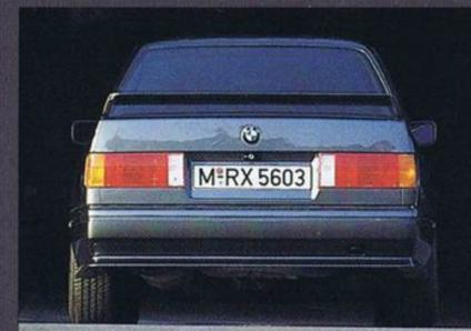
Optische Merkmale des M3 sind die in Wagenfarbe lackierten Front- und Heckschürzen, die flacher gestellte Heckscheibe, der Heckspoiler sowie die auf die Bereifung abgestimmten Seitenteile vorn und hinten. Mit diesen aerodynamischen Hilfen wird ein sehr guter  $c_w$ -Wert sowie eine beachtliche Auftriebsreduzierung an Vorder- und Hinterachse erzielt. Die Qualität der sportlichen Ausstat-
