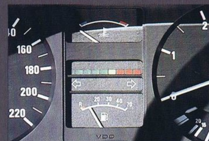
3 テストボタンを押してください。そうすれば警告ランプは消えますが、チェック箇所を知らせる発光ダイオードはなお点灯したままになります。(8)
