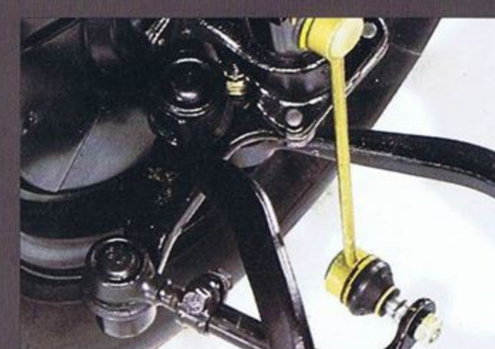
7 世界で最も効率がよく、安全性にも優れていると認められた、BMWシャシー設計。それは、フロントにスプリングストラット、リアにセミトレーリング・アームを配しています。そして今、BMW5シリーズのシャシー・コンセプトはさらに高められました。BMWの特許のダブルジョイント・スプリングストラット・フロントアクルスと、スイープバック角13度の新開発セミトレーリング・アーム・リアアクスルの採用です。これにより、加速時のダイブが大幅に減少しました。(7)
