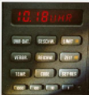
Der Bordcomputer ist ganz einfach, auch vom Lenker aus, zu bedienen. Seine Funktionen reichen von der Drehmomentüberwachung
